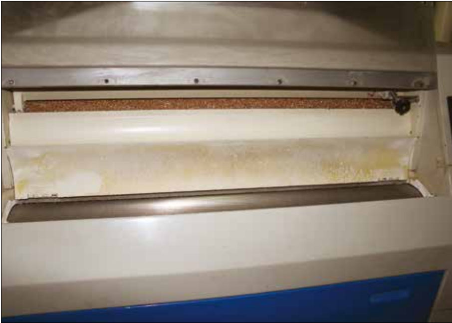
Figura 2.2 - Particolare dei rulli all'interno delle macchine per la macinazione delle farine. (Mulino Gismondi, Puglianello, Bn).
