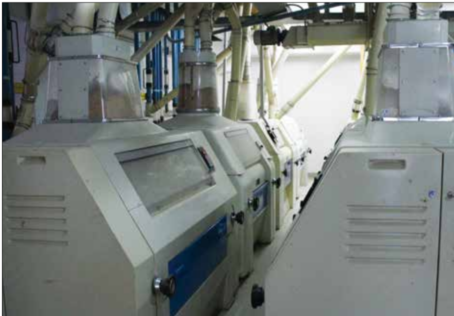
Figura 2.1 - Macchine per la macinazione delle farine (Mulino Gismondi, Puglianello, Bn).
